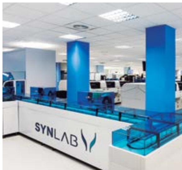
Cadena robotizada de 80 metros y 19 instrumentos en el Core Lab, Grupo SYNLAB Iberia
